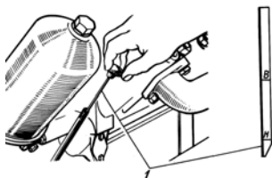
Рис. 3. Проверка уровня масла: 1 - указатель уровня масла
