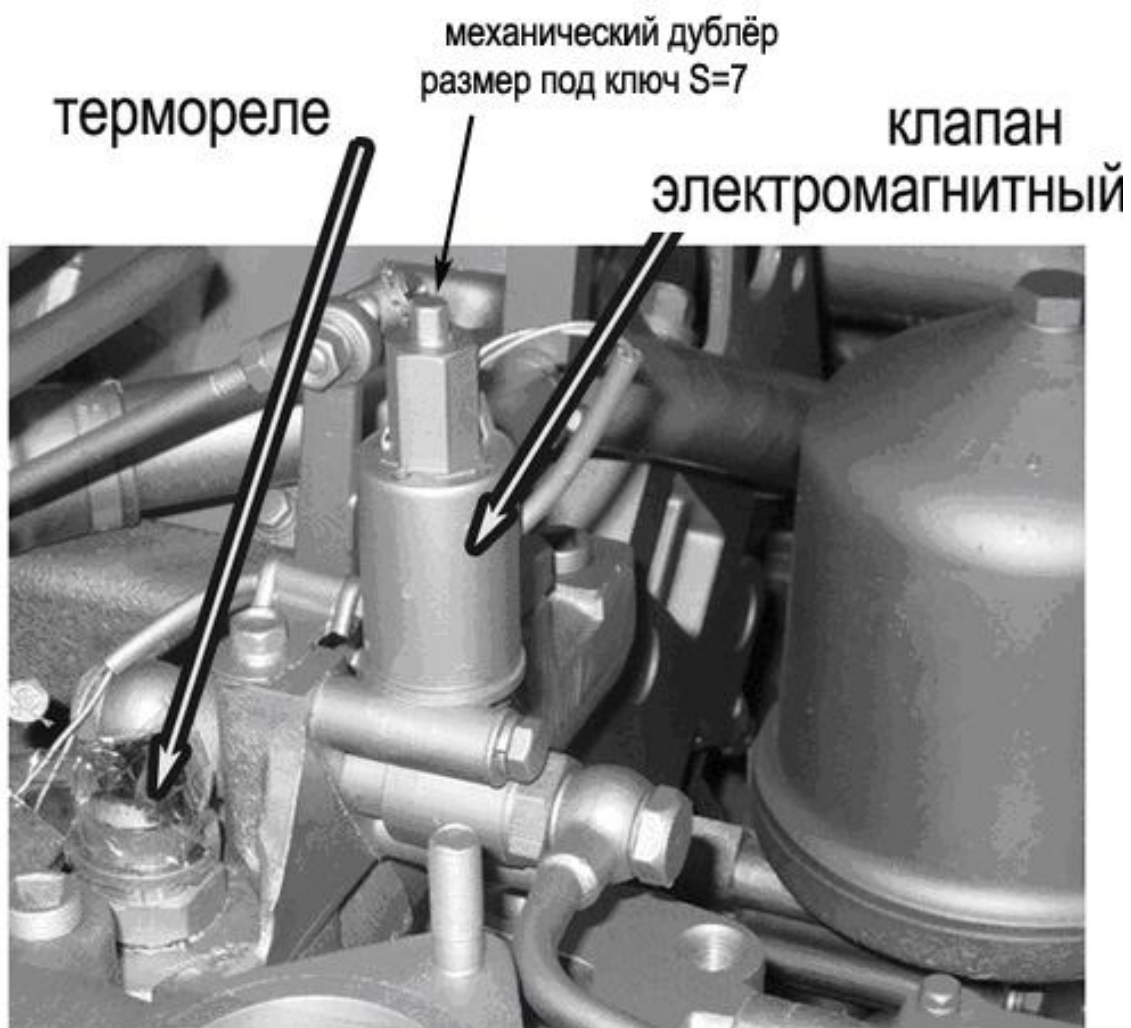
Устройство включения привода вентилятора
